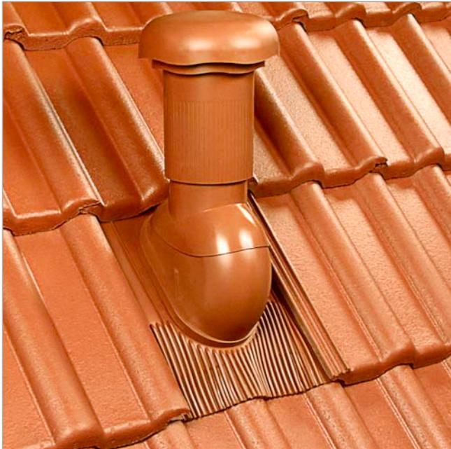
Die flexible Grundplatte in DN 125 passt sich durch die obere und untere Plissierung an die jeweilige Pfannenform an und fügt sich mit den formbaren seitlichen Passstreifen in die Deckung ein.
