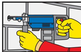
Bohren des Loches mit einer elektrischen Bohrmaschine auf den Durchmesser und die erforderliche Tiefe. Der Bohrlochdurchmesser muss der Ankergröße entsprechen.
