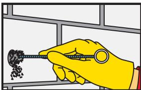
Das Bohrloch muss mit der speziellen Stahlbürste (Pinsel mindestens 2 mal) gründlich gereinigt werden. Der Durchmesser der Bürste muss größer sein als der Durchmesser der Bohrung.
