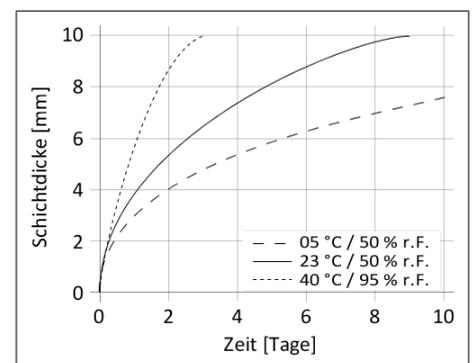
Diagramm 1: Aushärtegeschwindigkeit Sikasil® WS-200
