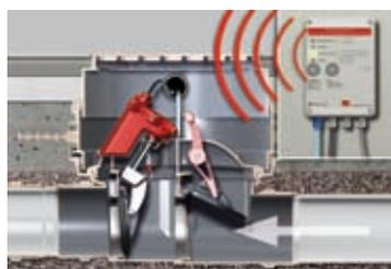
Bei Rückstau schließt der Betriebsverschluss automatisch. Ein optisches und akustisches Signal erfolgt
