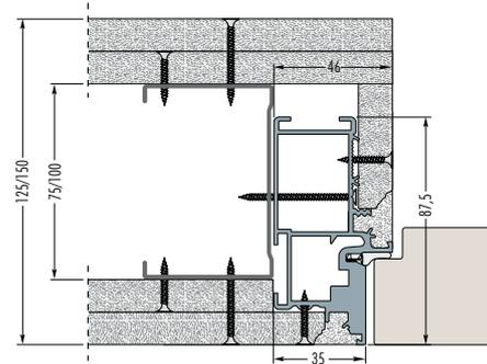
Achtung! Die Unterkonstruktion für die Zarge „Syntesis Wing“ ist lt. ÖNORM 3415 herzustellen. Bei einem Türblattgewicht über 25 kg (inkl. Beschläge) sind ausschließlich UA-Profile für den Anschluss der Zarge zu verwenden. Die Profilbreite ergibt sich aus der gewünschten fertigen Wandstärke und der Beplankungsstärke. Die Profile sind raumhoch einzusetzen, inkl. Türpfosten-Steckwinkel oben und unten.
