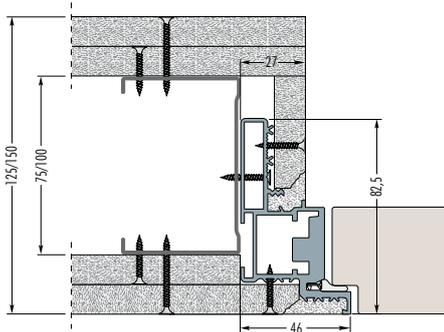
Die Zarge kann sowohl in eine Trockenbau- als auch in eine Massivwand eingesetzt werden. Die für die Verankerung in Massivwänden erforderlichen Teile sind im Lieferumfang enthalten.
