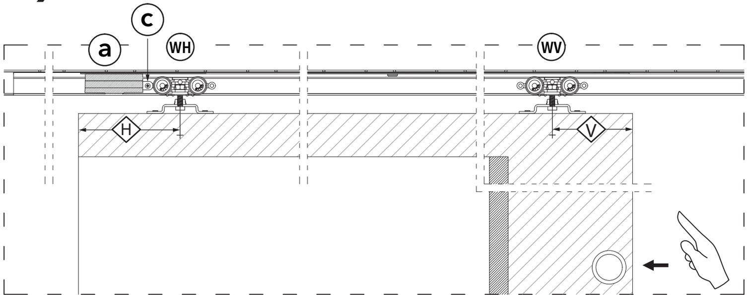
Wenn jetzt zum ersten Mal ein Holztürblatt eingebaut wird: Um ein korrektes Ausrichten der Laufachse des Türblattes zu ermöglichen, montieren Sie den Hängebeschlag um 2 mm versetzt zur Mittelachse.
