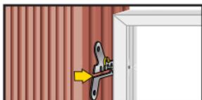
ProtectFIX Lasche von innen oder außen an der Fensterbauschraube FBS-Z einhängen. Die Schraube in eine der vier Aufnahmen positionieren und die Lasche waagrecht ausrichten.
