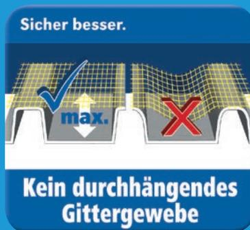
Der um 30% größere kapillarbrechende Hohlraum verhindert eine Rückdurchfeuchtung des Belages durch Stauwasser auf der Abdichtung.
