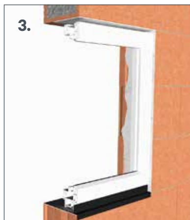
3. Meister System F Folienband zunächst unten waagrecht verkleben. Das Band klebt vollflächig und dient als äußere, schlagregendichte Ebene.
