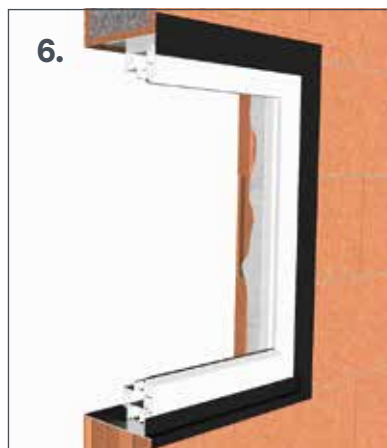
6. Meister System F Weichzellschaum vor dem Schäumen gut schütteln und die Fuge vorfeuchten. Überstehenden Schaum nach dem Durchhärten mit einem scharfen Messer abschneiden.
