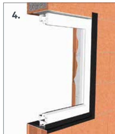
4. Das Folienband anschließend senkrecht verkleben. Auf eine gute Überlappung der Folien ist dabei zu achten. Meister System F Dichtkleber dient als zusätzliche Abdichtung bei Überlappungen, Falten, Tragklötzen und für das Gewerke Loch.
