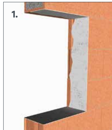
1. Die Oberfläche des Wandbildners muss gemäß ÖNORM B 5320 eben, tragfähig, nichtsandend und rissfrei sein. Erforderlichenfalls ist ein Glattstrich vorzusehen.
