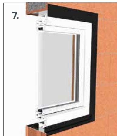
7. Zuletzt folgt das Einhängen des Fensterflügels und dessen Justierung.
