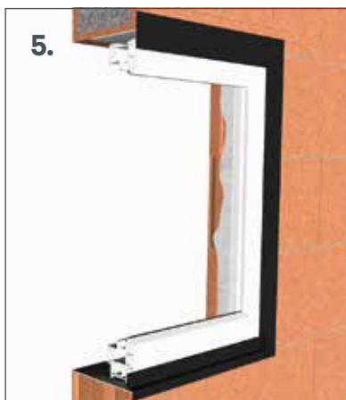
5. Das Folienband zuletzt oben waagrecht verkleben. Folie dabei gut anpressen.
