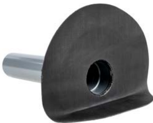
Flansch-Manschette aus PVC-Dachbahn (bis DN 150)
