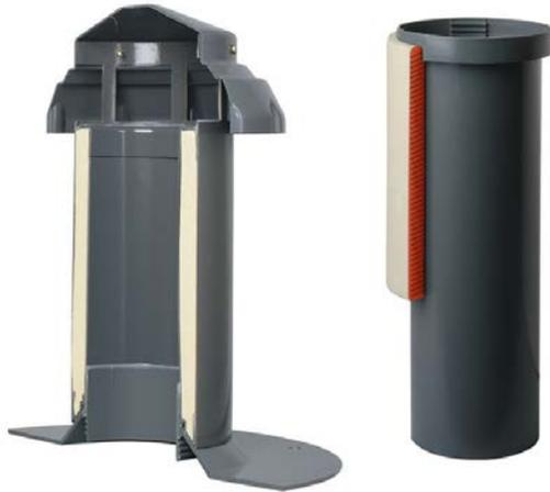
Wärmedämmte Wrasenlüfter reduzieren die Kondenswasserbildung in einem Lüfterrohr. Die gedämmte Konstruktion hält das Innenrohr im Abluftbetrieb auf höherer Temperatur, was wiederum den Taupunkt anhebt und die Kondensatbildung hemmt.
