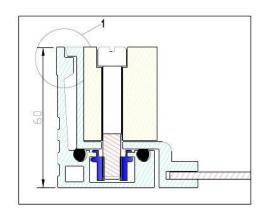
Schachtabdeckung für wählbare Oberflächen aus Aluminium, verschraubt, tagwasserdicht, mit Dichtung
