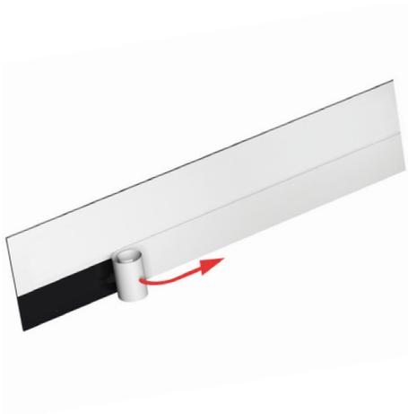
Das Fugenblech wird als Abdichtung für Arbeitsfugen und Sollrissquerschnitte in Bauteilen aus Beton verwendet. Die Elemente sind beidseitig komplett mit einer Spezialbeschichtung versehen. Die Verbindung der Spezialbeschichtung zum Frischbeton verhindert zuverlässig eine Unterwanderung des Fugensystems durch Wasser. Die hohe Elastizität der Beschichtung gewährleistet selbst bei Schwinden der Betonbauteile eine sichere Abdichtung.
