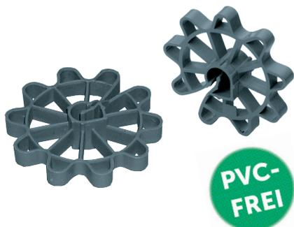
Einzelabstandhalter aus Kunststoff für verschiedene Eisendurchmesser zur Befestigung an horizontaler und senkrechter Bewehrung. Guter Betondurchfluss.
