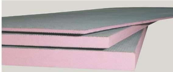
Beschichtetes Trägerelement als Untergrund für die Fliesenverlegung. Austrotherm XPS® TOP-Dämmplatte, beidseitig mit kunststoffvergütetem Mörtel beschichtet und mit Textilglasgitter armiert.
