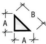
Dreikantleiste aus Kunststoff für die Herstellung von gleichmäßig gebrochenen Kanten in Betonbauteilen.
