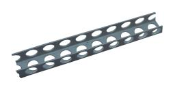
Linienförmiger Abstandhalter aus Kunststoff für großflächige horizontale Bewehrungslagen. Speziell für den Einsatz auf weichem Untergrund wie zB.: Dämmplatten geeignet. Guter Betondurchfluss.
