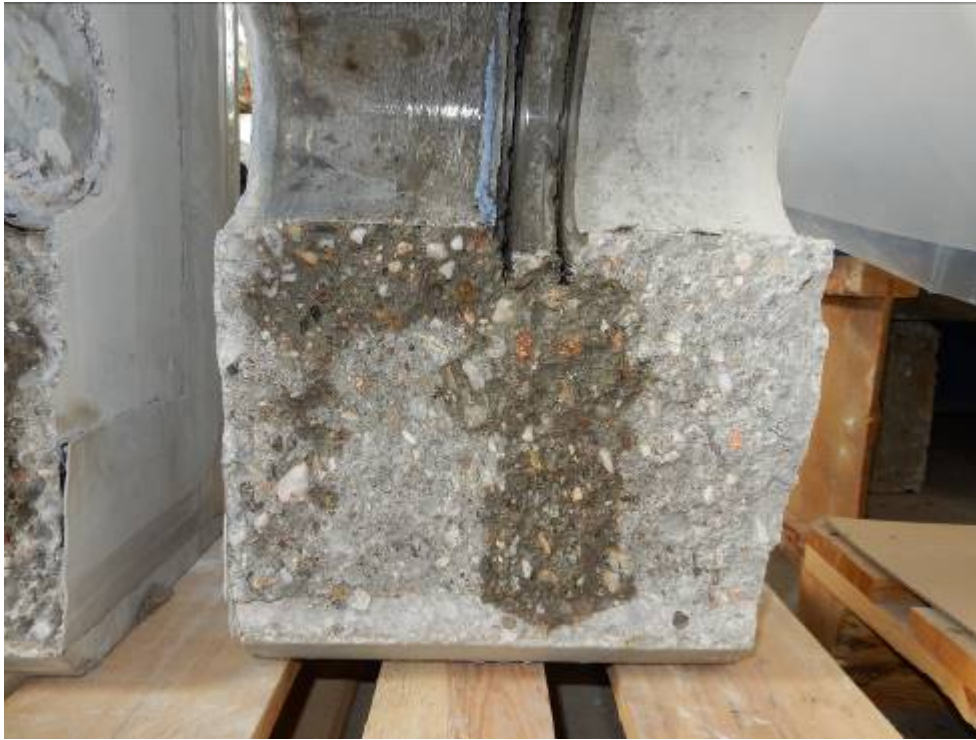
Bild 5 zur Überprüfung der Umläufigkeit gespaltener Prüfkörper mit nach unten ablaufendem Restwasser
