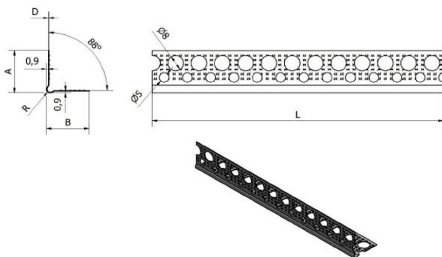
Die Profile an einem trockenen Ort in waagerechter Position lagern, damit es zu keiner Deformation kommt.
